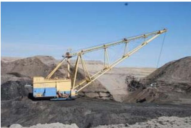
Nun stehen wir vor diesem Monstrum, die Schaufel so gross, dass zwei Lastwagen darin Platz darin gefunden hätten. Es ist ein Schreitbagger, er hat keine Raupen, sondern mehrere grosse Platten die mit Hydraulischen Zylindern fortbewegt werden. Er
